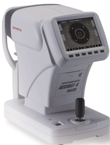
Rycina 4.2. Przykład autorefraktometru używanego do badania wady refrakcji
