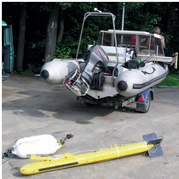
Rycina 1.28. Sonar boczny DF 1000 firmy EdgeTech używany podczas badań jezior Drawsko i Miedwie
