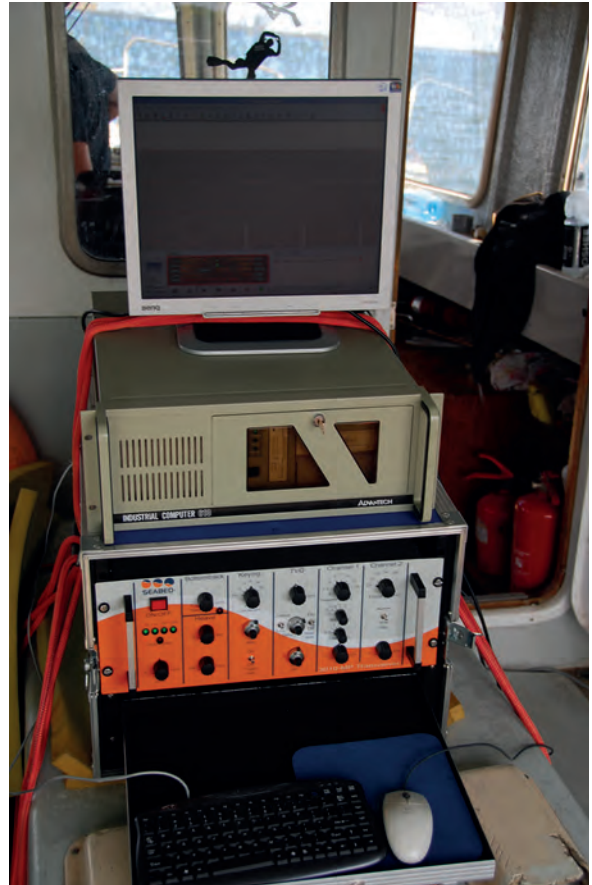
Rycina 1.29. System sejsmoakustyczny typu sub-bottom profiler firmy Seabed BV (Oretech Pipeliner 3010-MP)
