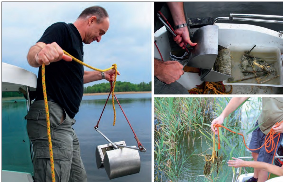
Rycina 2.4. Pobór prób osadów oraz roślin wodnych z dna jeziora Wigry za pomocą próbnika czerpakowego typu Van Veen oraz kotwiczki Figure 2.4. Sampling of sediment and aquatic plants from the bottom of the Wigry Lake using Van Veen grab and grapnel
