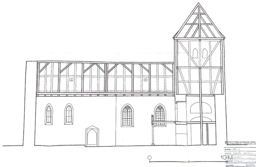
Ryc. 8. Rekonstrukcja przekroju podłużnego
